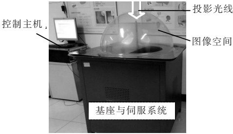
图 4 体显示系统样机 Fig. 4 Volumetric display prototype
